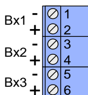
Рисунок 18. Разъем дискретных входов платы расширения
