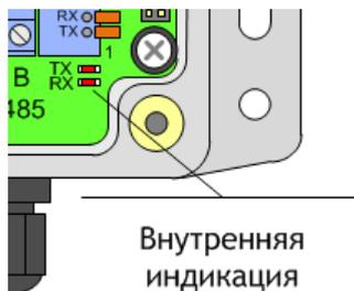
**Рисунок 6. Внутренняя индикация контроллера**
