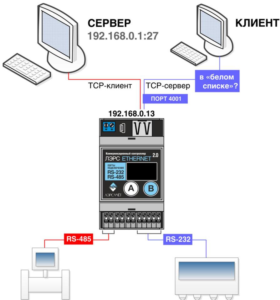
Заводские настройки: оба последовательных порта в режиме «TCP-сервер» (RS-232: порт 4001, RS-485: порт 4002), IP-адрес контроллера 192.168.0.5, маска 255.255.255.0 (DHCP отключен).
