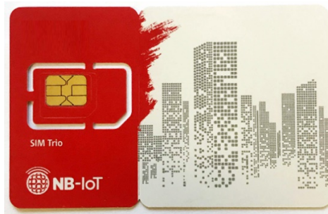
Рисунок 2. SIM-карта с технологией NB-IoT
