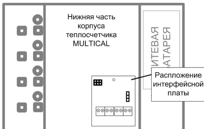
Проложить кабель RS-232 или RS-485 через уплотнители и подключить согласно таблице подключения.
