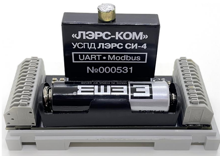
Рис. 1. Внешний вид счетчика импульсов ЛЭРС СИ-4 RS-232/485 со снятым корпусом (батарея в комплект не входит)
